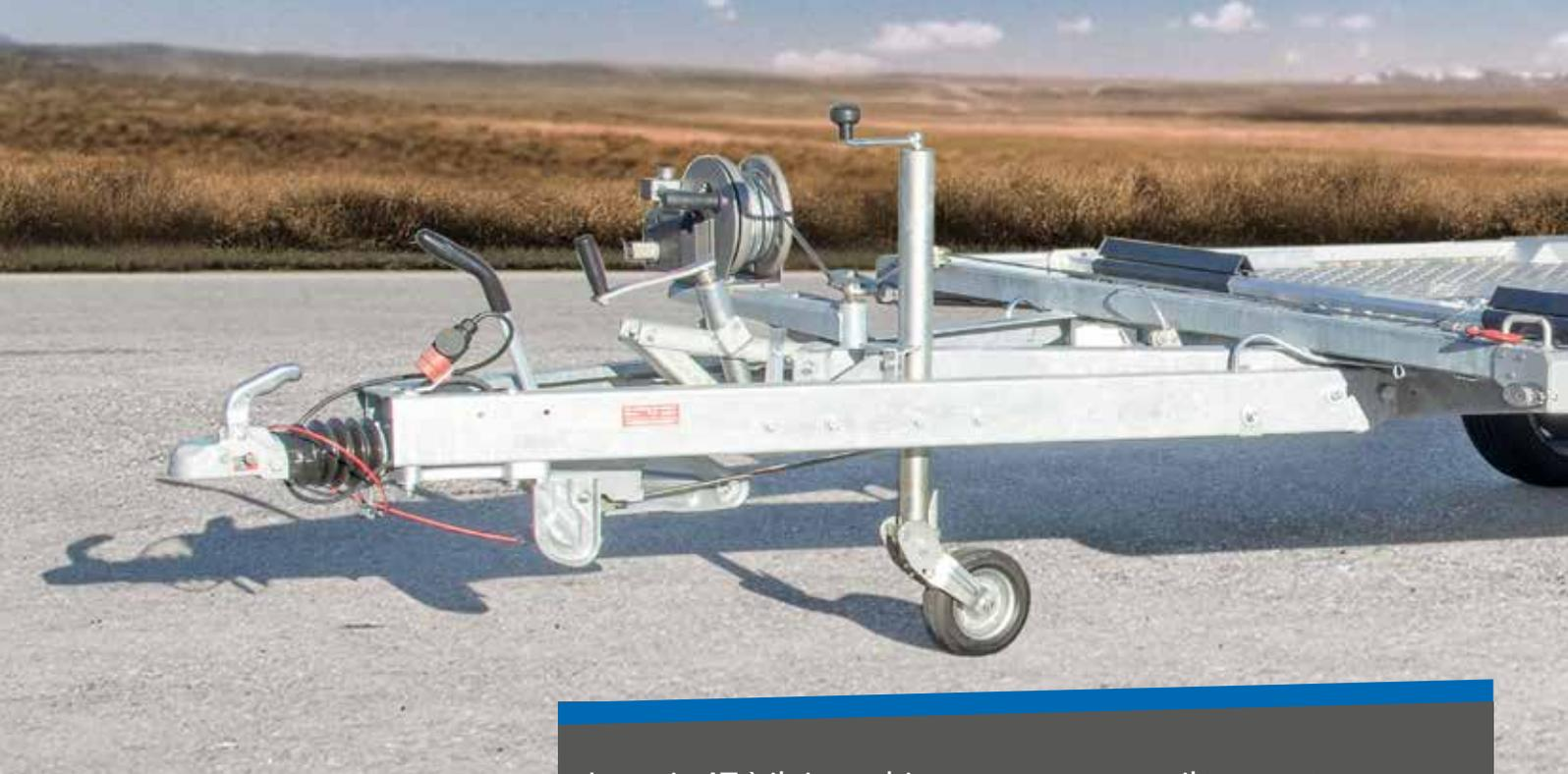
La serie AT è il rimorchio senza rampa per il trasporto professionale di automobili. I rimorchi leggeri ALGEMA si basano su un massiccio profilato del telaio, con struttura composita in alluminio e acciaio. Questo garantisce un'elevata rigidità torsionale e allo stesso tempo un elevato carico utile.
