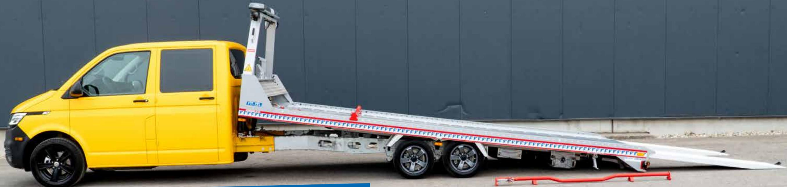
Der FIT-ZEL Speeder 2 erreicht nicht nur PKW-ähnliche Fahreigenschaften, sondern bietet hohe Sicherheit und Wirtschaftlichkeit beim Einsatz. Möglich wird dies durch eine serienmäßige automatische Luftfederung der beiden 1.600 kg-Hinterachsen sowie die integrierten Scheibenbremsen.
