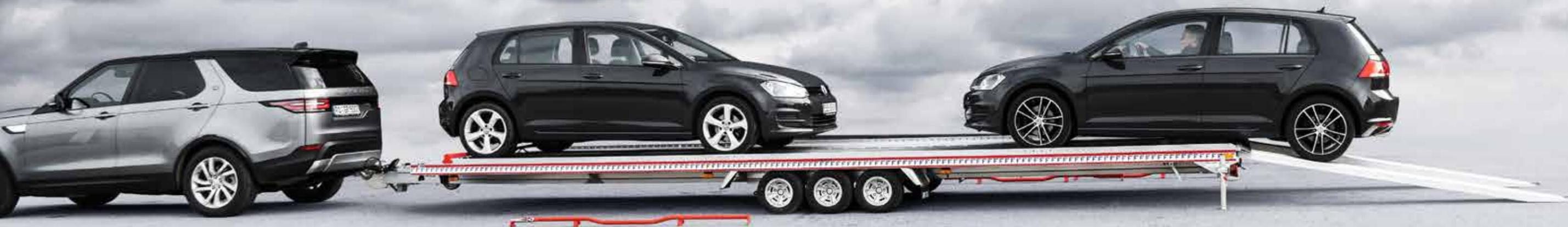
Mit den Anhängern der FIT-ZEL Duo-Baureihe stehen besonders leichte Anhänger zur Verfügung, die nicht nur durch die Vollaluminium-Konstruktion, sondern auch durch ein ausgezeichnetes Nutzlastverhältnis punkten können.
