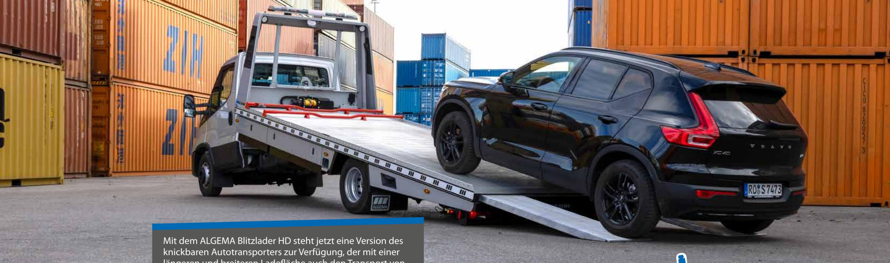
Mit dem ALGEMA Blitzlader HD steht jetzt eine Version des knickbaren Autotransporters zur Verfügung, der mit einer längeren und breiteren Ladefläche auch den Transport von schwereren Fahrzeugen ermöglicht. Für Heavy Duty steht die beeindruckende Nutzlast bis zu 3,6 Tonnen. Dank der breiteren und längeren Ladefläche werden die Transportmöglichkeiten nicht nur bei Transportern deutlich erweitert.
