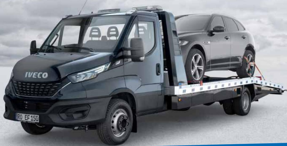
Der Autotransporter ALGEMA Festplateau 2 mit Alu-/Stahl-Compound-Bauweise ist eine robuste und wirtschaftliche Lösung für den soliden Autotransport.
