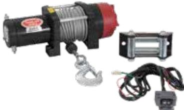
Die 12V-ComeUp-Elektroseilwinde CUB 3 hat einen Permanentmagnetmotor mit geringem Stromverbrauch und ein dreistufiges Planetengetriebe. Ebenfalls ist die Seilwinde mit einer automatischen Lasthaltebremse und einer Freilaufkupplung zum Abziehen des Seils von Hand ausgestattet. Die Elektroseilwinde ComeUp CUB 3 ist eine sehr gute Alternative zur Handseilwinde und für geringe Lasten geeignet.
