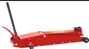
2t heavy duty Rangierwagenheber 800 mm, ideal für die Anwendung in der Landtechnik. Für große Hubhöhen. Mit robustem Stahlrahmen für maximale Haltbarkeit, Sicherheits-Bypass Überlastsystem, Fußpedal für schnelles Hochfahren, präzises Handablassventil.
