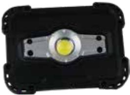
Tragbarer Arbeitsscheinwerfer mit stabilem Aluminiumgehäuse und Gummikantenschutz. Ein 5 V USB Ausgang ermöglicht die Verwendung als Powerbank. Zur Ausstattung gehört eine Ladezustandsanzeige, Überladeschutz, Entladeschutz und automatische Abschaltfunktion Lichtstrom 400 lm 50% und 800 lm 100%
