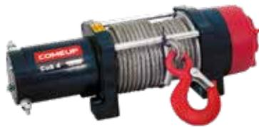
Die 12 V-ComeUp Elektroseilwinde CUB 4 hat einen Permanentmagnetmotor mit geringem Stromverbrauch und ein dreistufiges Planetengetriebe. Ebenfalls ist die ComeUp CUB 4 Seilwinde mit einer automatischen Lasthaltebremse und einer Freilaufkupplung zum Abziehen des Seils von Hand ausgestattet. Die Elektroseilwinde ComeUp CUB 4 ist eine sehr gute Alternative zur Handseilwinde und für geringe Lasten geeignet.
