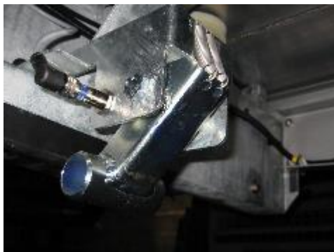
Capteur d'inclinaison à l'extrémité inférieure arrière du plateau
