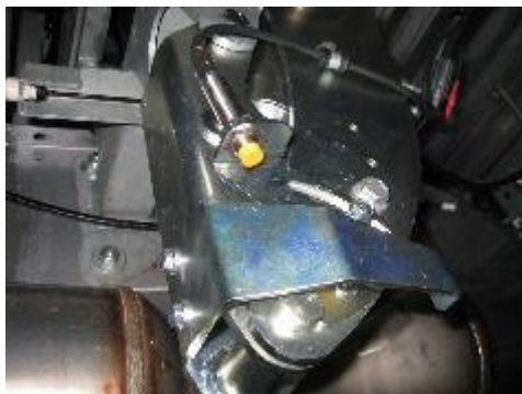
Capteur de position finale de la cisaille à bascule monté sur le côté de la cisaille à bascule.
