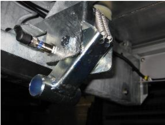
Capteur d'inclinaison avec interrupteur à bascule à l'extrémité inférieure arrière du plateau
