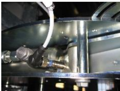
Capteur de ciseaux basculants fermé à l'arrière entre les joues latérales des ciseaux basculants.
