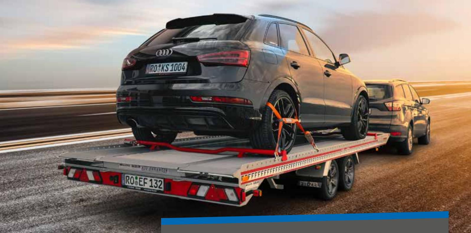
Der Euro-Trans ist ein vielseitiger Aluanhänger für den professionellen Fahrzeugtransport. Bis zu 2.9 t Nutzlast machen den Euro-Trans in seiner Klasse einzigartig. Dafür sorgt die besonders leichte Voll-Aluminium-Konstruktion mit Selbstkippsmechanismus.
