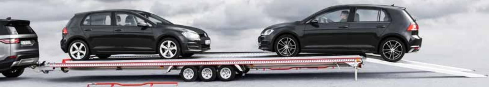
Mit den Anhängern der FIT-ZEL Duo-Baureihe stehen besonders leichte Anhänger zur Verfügung, die nicht nur durch die Vollaluminium-Konstruktion, sondern auch durch ein ausgezeichnetes Nutzlastverhältnis punkten können.
