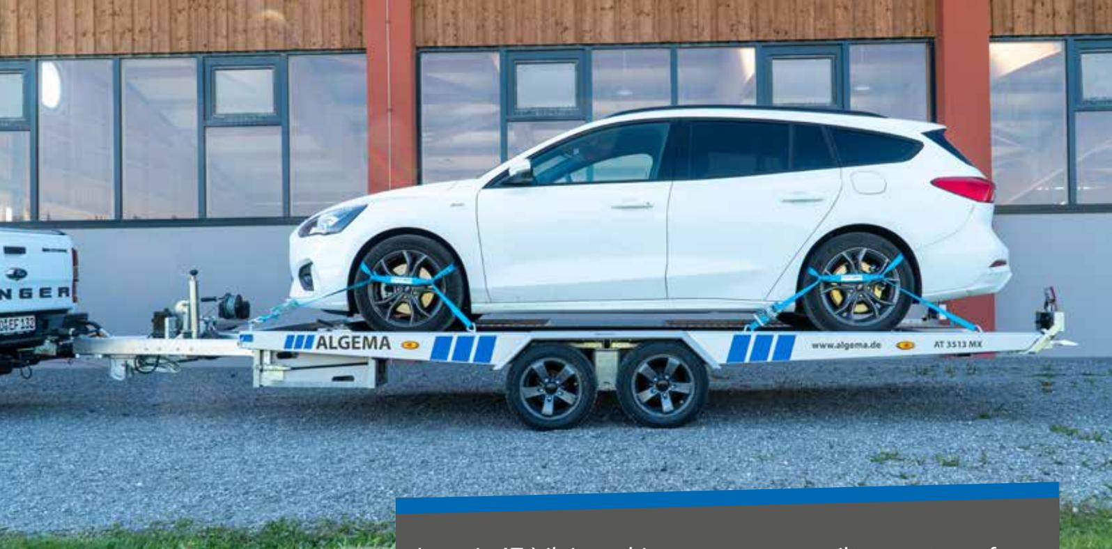
La serie AT è il rimorchio senza rampa per il trasporto professionale di automobili. I rimorchi leggeri ALGEMA si basano su un profilo di telaio massiccio in costruzione in alluminio/acciaio. Questo garantisce un'elevata rigidità torsionale e allo stesso tempo un elevato carico utile.
