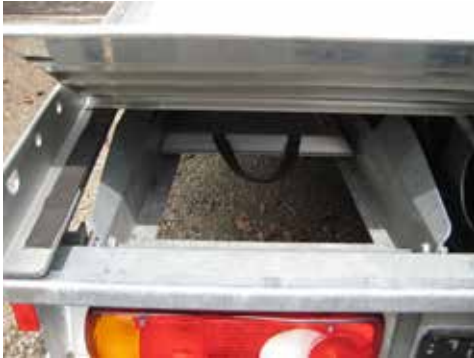
Zusatzrampe vollständig eingeschoben (Abbildung ohne serienmäßige Auffahrrampe)
