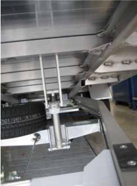
Plateau aufgekippt mit eingefahrener hydraulischer Kippeinrichtung (nicht aktiv).
