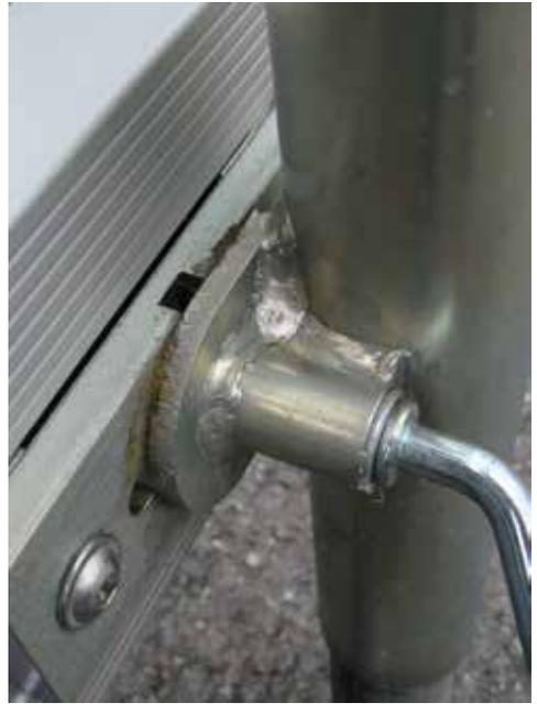
Knebelschraube angezogen, ohne Spalt zwischen Zylinderrohr und Deichsel.
