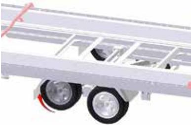
Die optionale Liftachse der Pendelachse kann bei Fahrten mit unbeladenem Transportanhänger angehoben werden, solange die zulässige Stützlast nicht überschritten wird. Darüber hinaus dient die Liftachse auch als Rangierhilfe, um den unbeladenen Transportanhänger leichter per Hand schieben zu können. Die Liftachse senkt automatisch ab, sobald die Plateauverriegelung ausgelöst und das Plateau aufgekippt wird .
