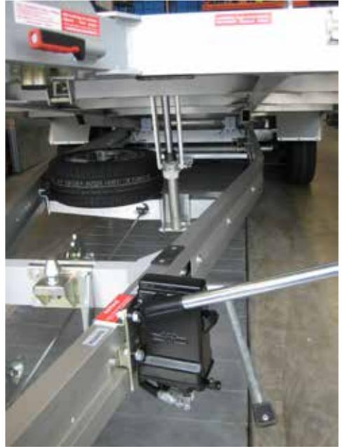
Plateau aufgekippt mit ausgefahrener hydraulischer Kippeinrichtung (aktiv).
