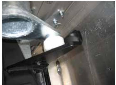
Liftachswelle mit Hydraulikzylinder (oben)
