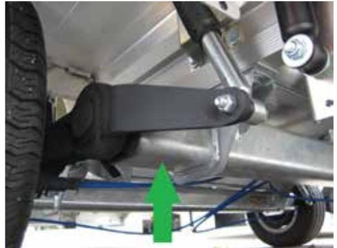
Gummifederachse T-, Z-, und N-Ausführung
