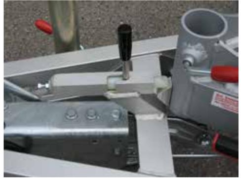
Plateaurückhalteautomatik geschlossen (Entladen mit gelöster Plateaverriegelung)
