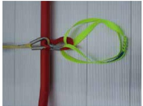
Bei Transportanhänger mit Handseilwinde wird anstelle der Achterschlinge eine Anhängeschlaufe (Bandschlinge) mitgeliefert. Die Anhängeschlaufe ist sinngemäß wie die Achterschlinge einzusetzen.
