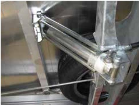
Hydraulische Kippeinrichtung bei abgekipptem Plateau unter dem Transportanhänger.
