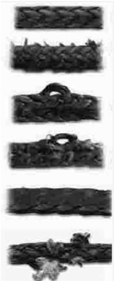
Unbeschädigtes Seil mit normalem Durchmesser, zum Gebrauch geeignet.
